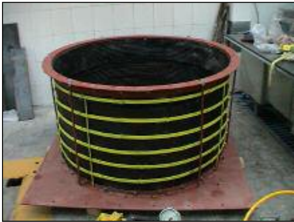
شکل ۱۰- نمایی از ظرف مدل خاک ساخته شده
