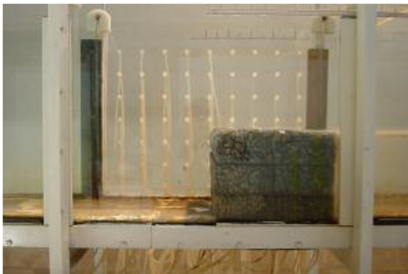
شکل ۲ - مدل آزمایشگاهی بند توری سنگی با نمای آب‌بند در بالادست
