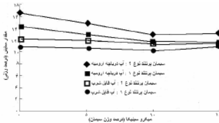
شکل ۴- مقدار سایش مخلوطهای میکروسیلیس دار نگهداری شده در آبهای معمولی و دریاچه ارومیه
