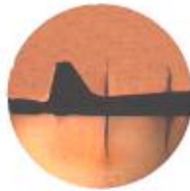
شکل ۳-الف) موج ناپایا در انتهای مدل با یک دم عمودی در زمان راه اندازی تونل، \alpha=0^\circ
