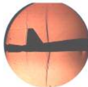
شکل ۳-ه) موج ناپایا در انتهای مدل با دم عمودی دوتایی در زمان راه اندازی تونل، \alpha=0^\circ
