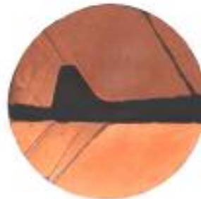
شکل ۳-ج) موج ناپایا روی بخش انتهای مدل با یک دم عمودی، \alpha=0
