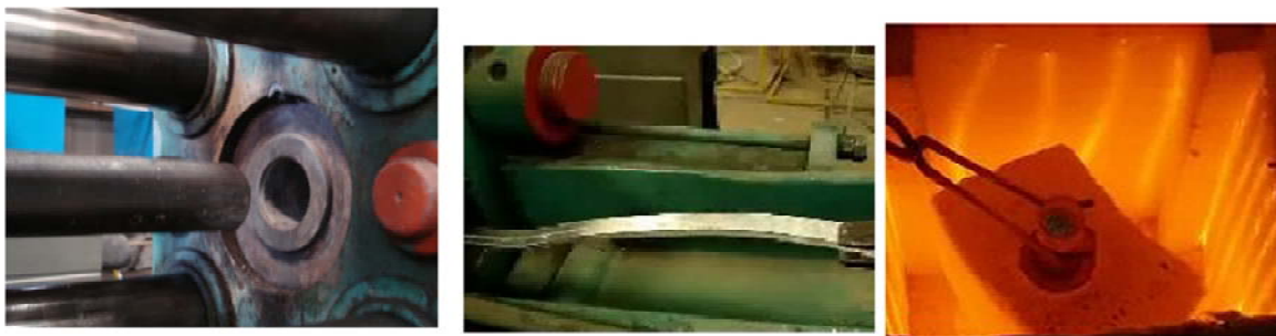
فوم کردن تکه‌ای از تسمه در قالب داخل کوره → اکستروژن گرم
