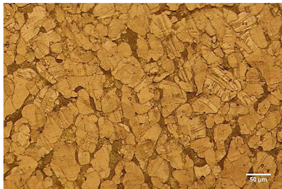
شکل ۳- ریزساختار نمونه پس از پاس دوم
