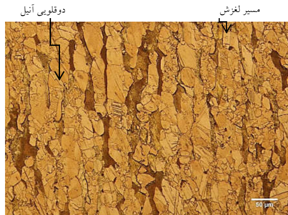
شکل ۲- ریزساختار نمونه پس از پاس اول
