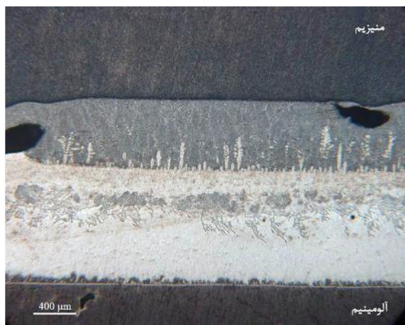
شکل ۶- تصویر میکروسکوپی نوری از نمونه ریخته‌گری شده در سرعت دوران ۱۶۰۰ دور بر دقیقه
