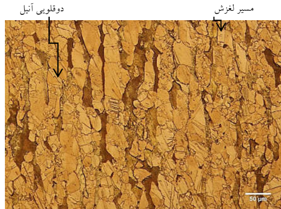
شکل ۲- ریزساختار نمونه پس از پاس اول
