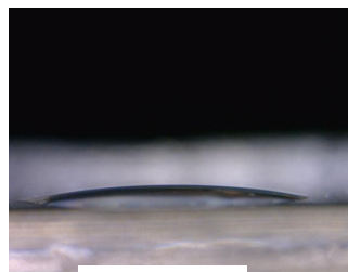
شکل ۷- زاویه تماس قطره آب روی سطح لایه نازک نانوکامپوزیتی MgF_2-2\%SiO_2
