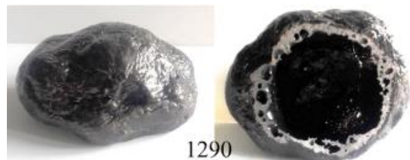
شکل ۱۰- تصویری از ظاهر و سطح زیرین نمونه SG50-5SiC در ۱۲۹۰ درجه سانتی گراد
