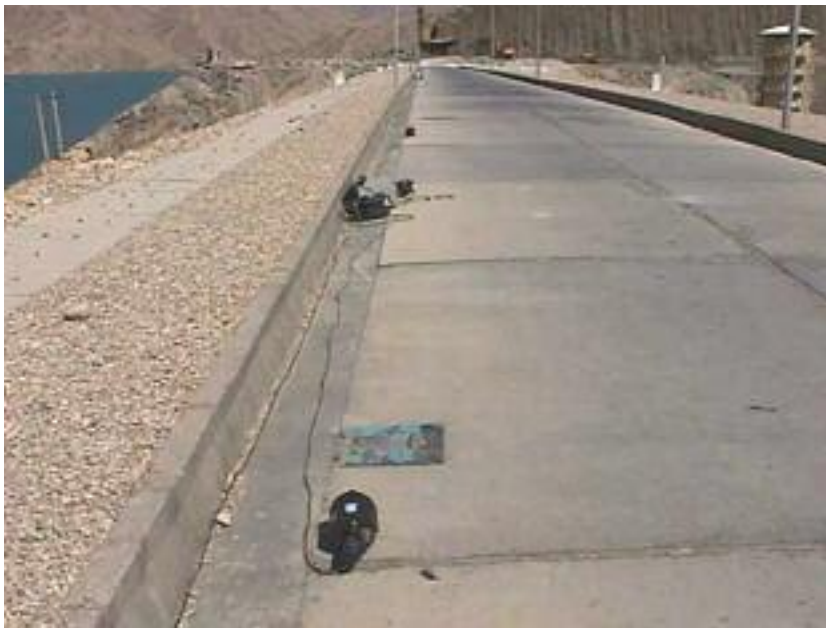
شکل ۳- نمایی از تاج سر (دید از سمت راست به چپ) و نمونه‌ای از آرایش حسگرها
