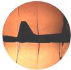
شکل ۳-ب) حرکت موج ناپایا در انتهای مدل با یک دم عمودی بعد از گذشت زمان، \alpha=0^\circ
