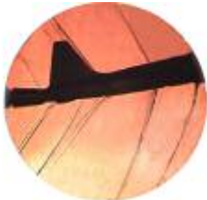
شکل ۳-د) موج ناپایا روی بخش انتهای مدل با یک دم عمودی، \alpha=6^\circ
