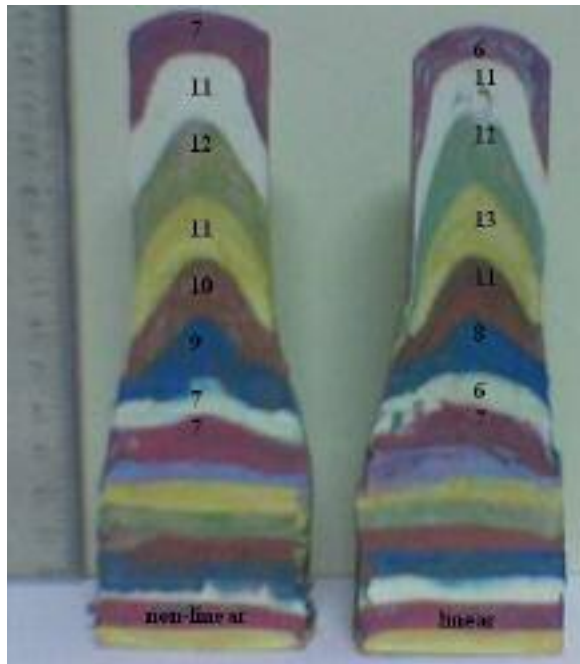
شکل ۲۰ - ضخامت لایه‌ها بر روی محور اکستروژن
