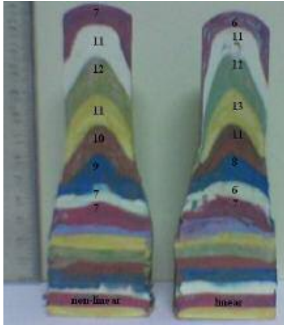
شکل ۲۰ - ضخامت لایه‌ها بر روی محور اکستروژن
