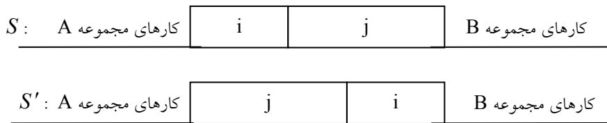
شکل ۱- تعویض جفتی دو کار i و j
