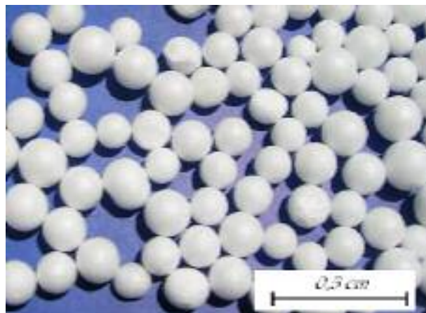
شکل ۱- تصویر دانه‌های فومی پیش‌شکفته مورد استفاده در ساخت ملاط فومی.
