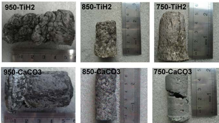
شکل ۴- اثر دمای فوم سازی بر رفتار انبساطی دو پیش- ماده چگال A و B (جدول ۲)، حاوی TiH_2 و CaCO_3
