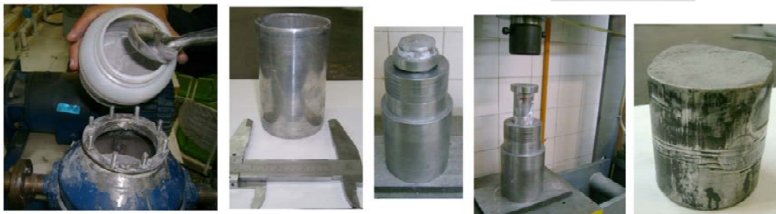
پودر پرس شده → پرس سرد → قالب و سمبه فولادی → Al استوانه‌ای → آسیا جهت مخلوط کردن
