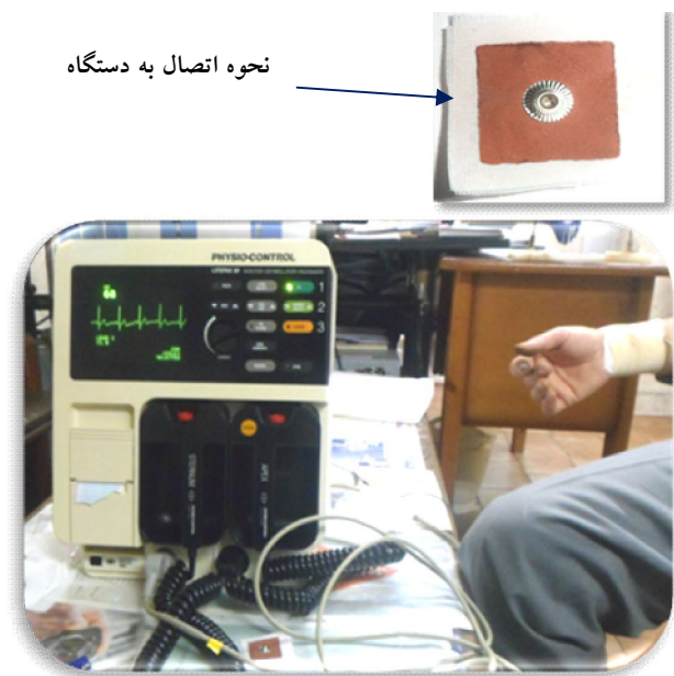
شکل ۲- تصویر حسگر چاپی و نحوه اتصال آن با دستگاه الکترود شوک مانیوتورینگ
