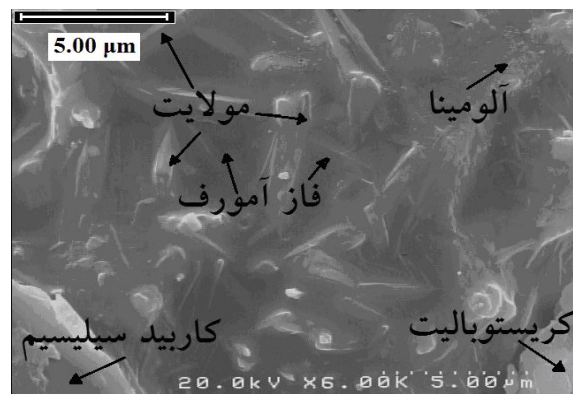
شکل ۶- تصویر میکروسکوپی الکترونی روبشی ریزساختار نانوکامپوزیت آلومینا-کاربید سیلیسیم اتصال مولایتی بدون نانوتیتانیا
