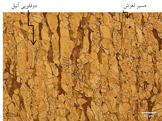
شکل ۲- ریزساختار نمونه پس از پاس اول
