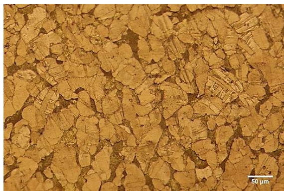
شکل ۳- ریزساختار نمونه پس از پاس دوم
