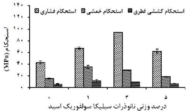
شکل ۷- نمودار ستونی مقادیر استحکام فشاری، خمشی و کششی قطری برای نمونه‌های سیمان گلاس آینومر کامپوزیتی حاوی درصد‌های وزنی مختلف نانوذرات سیلیکا سولفوریک اسید
