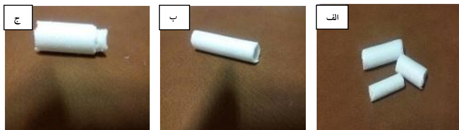
شکل ۱- الف) چند نمونه داربست همگن، ب) لایه داخلی داربست گرادایانی و ج) داربست گرادایانی
