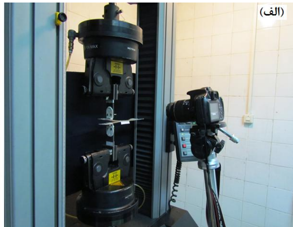
شکل ۳- الف) نمایی از دستگاه کشش در حین آزمایش برش بین لایه‌ای و ب) نحوه قرار گرفتن نمونه در بین فک‌های دستگاه
