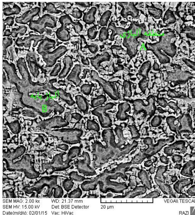
شکل ۳- تصویر میکروسکوپی الکترونی روبشی دو منطقه A و B که تحت آزمون پراش انرژی پرتو ایکس قرار گرفتند (رنگی در نسخه الکترونیکی)
