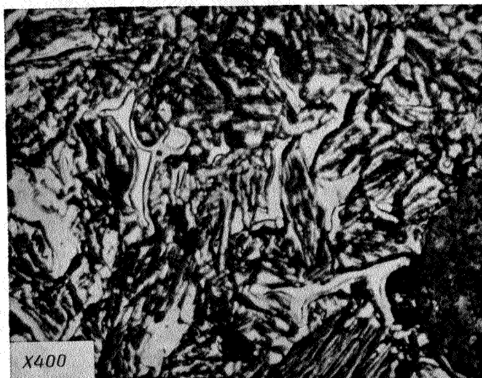
شکل ۹ - تصویر میکروسکوپی نوری از آلیاژ آستمپر شدن در دمای ۳۷۰ درجه سانتیگراد به مدت ۱۰ دقیقه [ ساختار میکروسکوپی شامل آستنیت باقیمانده (فاز روشن) و فریت بینیتی (فاز تیره) است ]
