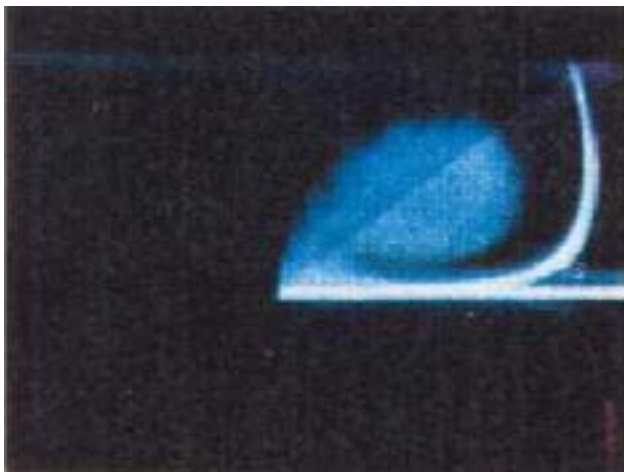
شکل ۸-ب- خطوط هم‌فشار در میدان جریان بر روی بال در زاویه حمله ۳۵ درجه
