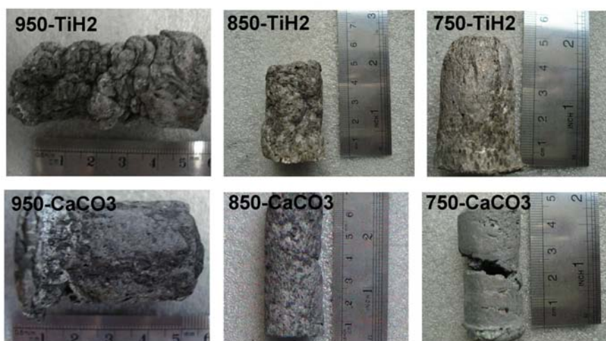
شکل ۴- اثر دمای فوم سازی بر رفتار انبساطی دو پیش- ماده چگال A و B (جدول (۲)، حاوی \text{TiH}_2 و \text{CaCO}_3 )
