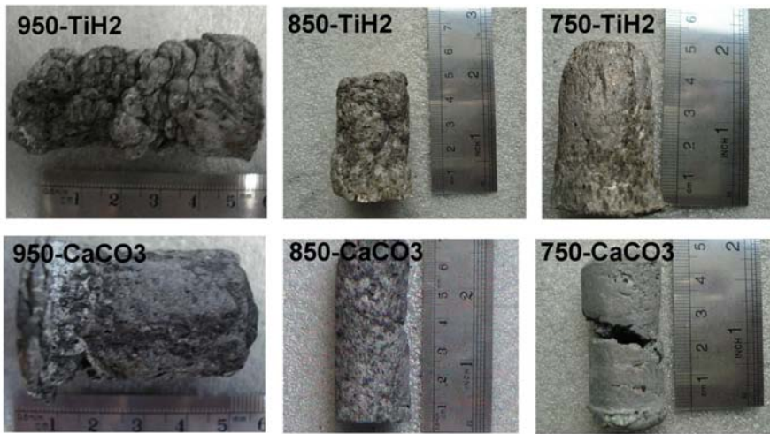
شکل ۴- اثر دمای فوم سازی بر رفتار انبساطی دو پیش- ماده چگال A و B جدول (۲)، حاوی TiH_2 و CaCO_3
