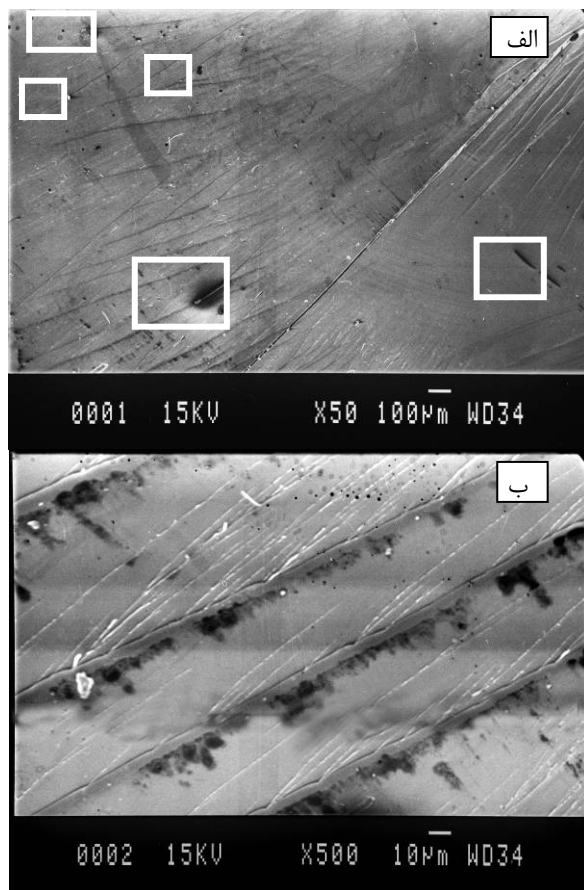
شکل ۵ - ریزساختار سطح شکست رزین فنولیک
