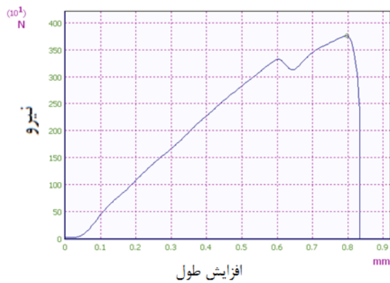
شکل ۷- نمودار نیرو-تغییر طول مربوط به نمونه لحیم شده با فلز پرکننده پایه تیتانیوم با فاصله توقف ۰/۰۶ میلی متر
