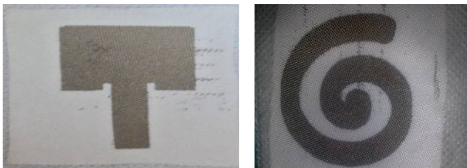
شکل ۱۷- اشکال مختلف پیچ رسانا چاپ شده بر روی پارچه
