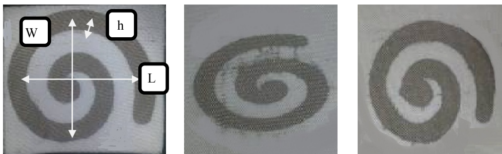
شکل ۱۳- پچ‌های مارپیچ چاپ شده بر روی پارچه پلی استر در سه سایز مختلف نمونه ۱ نمونه ۲ نمونه ۳
