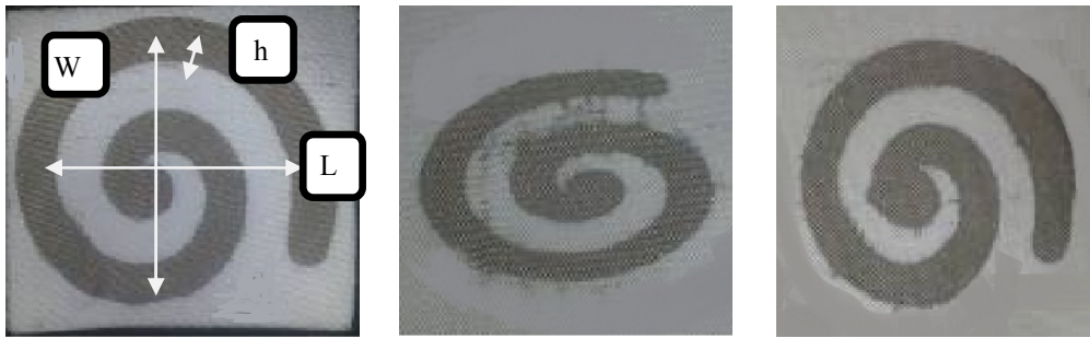
شکل ۱۳- پیچ‌های مارپیچ چاپ شده بر روی پارچه پلی استر در سه سایز مختلف نمونه ۱ نمونه ۲ نمونه ۳
