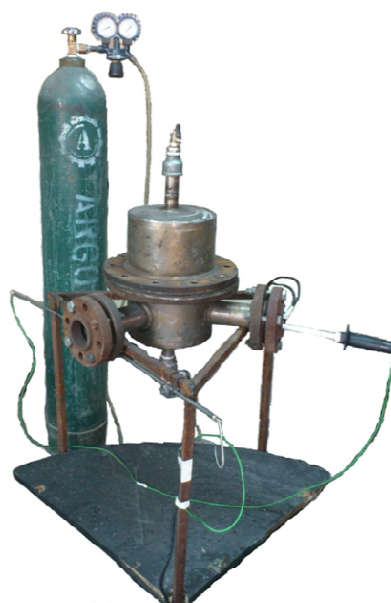
شکل ۲ - تصویر محفظه ساخته شده انجام واکنش خود احتراقی (اشتعال نمونه توسط شعله).
