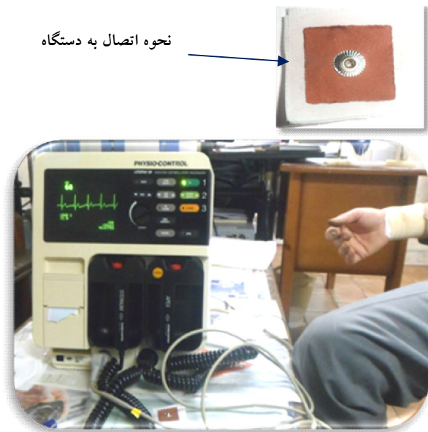
شکل ۲- تصویر حسگر چاپی و نحوه اتصال آن با دستگاه الکتروشوک مانتیورینگ
