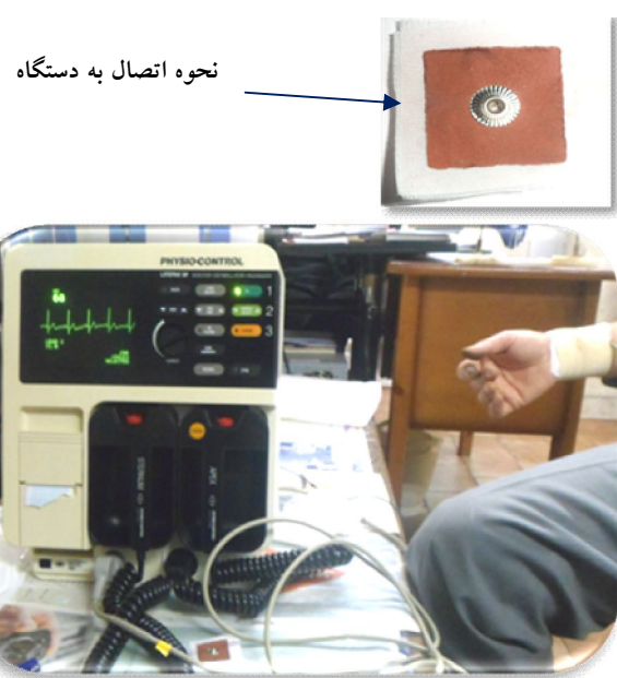
شکل ۲- تصویر حسگر چاپی و نحوه اتصال آن با دستگاه الکتروشوک مانتیورینگ
