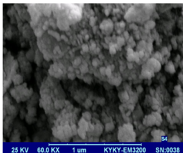
شکل ۷- تصویر میکروسکوپ الکترونی روبشی نمونه تولید شده در دمای ۱۸۰ درجه سانتی‌گراد به مدت ۸ ساعت بدون حضور پلی اتیلن گلیکول
