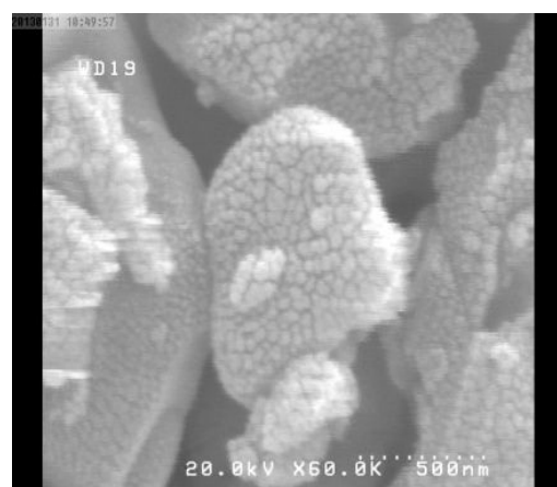
شکل ۳- تصویر میکروسکوپ الکترونی روبشی از شکل و اندازه ذرات سرامیک‌ها
