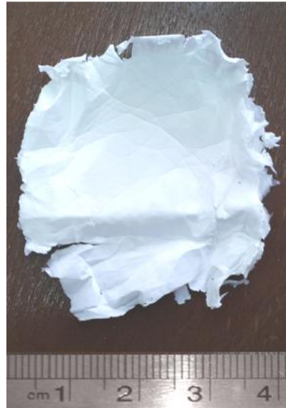
شکل ۱- تصویر الیاف شیشه زیست فعال پس از الکترورسی با ولتاژ ۱۹ کیلو وات، نرخ تغذیه ۰/۸ میلی‌لیتر بر ساعت و فاصله نازل تا جمع‌کننده (جمع‌کننده ثابت) ۱۰۰ میلی‌متر
