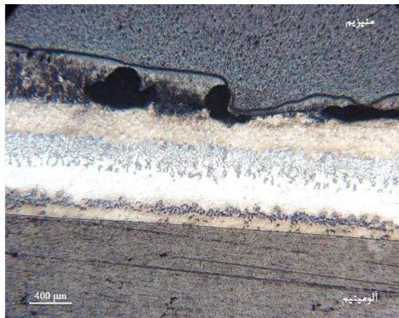
شکل ۵- تصویر میکروسکوپی نوری از نمونه ریخته‌گری شده در سرعت دوران ۱۲۰۰ دور بر دقیقه
