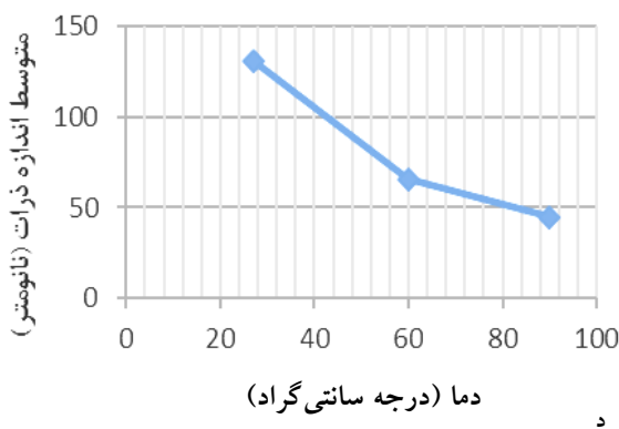
شکل ۳- نمودارهای تغییرات متوسط اندازه ذرات نمونه‌های سنتز شده با تغییر الف) نسبت وزنی پلی‌وینیل‌پیرولیدون به نقره نیترات، ب) نسبت وزنی گلوکز به نقره نیترات، ج) سرعت تزریق واکنش‌دهنده‌ها به یکدیگر و د) دما
