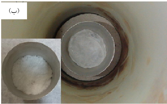
شکل ۲- تصاویر نمونه \text{CaB}_4\text{O}_7 تحت فرایند حرارتی: (الف) شروع خروج گازها از نمونه در دمای ۲۲۴ درجه سانتی‌گراد و (ب) بازگشت حباب به محتویات داخل بوتله در دمای ۲۸۰ درجه سانتی‌گراد (تصویر موجود در ضمیمه، نمونه را پس از اتمام فرایند حرارتی نشان می‌دهد)
