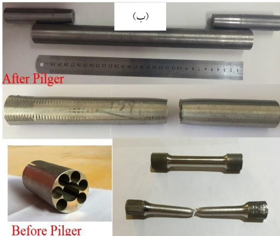
شکل ۶-الف) نتیجه آزمون کشش سرد لوله AISI321 پیلگر شده در مقایسه با نمونه پیش از فرایند و ب) نمونه‌ها قبل و پس از آزمون کشش
