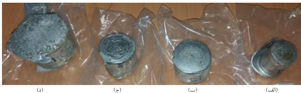
شکل ۳- نمونه مذاب کوئنچ شده پس از: الف) ۲۰، ب) ۱۵، ج) ۱۰ و د) ۵ ثانیه هم‌خوردن از دمای ۶۴۰ درجه سانتی‌گراد
