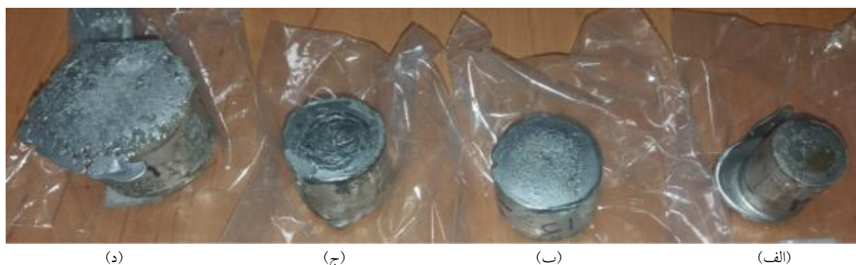
شکل ۳- نمونه مذاب کوئچ شده پس از: الف) ۲۰، ب) ۱۵، ج) ۱۰ و د) ۵ ثانیه هم‌خوردن از دمای ۶۴۰ درجه سانتی‌گراد
