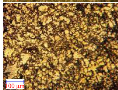
شکل ۶- تصاویر ریزساختار نمونه های ریخته گری با افزودن براده به سطح مذاب و کف بوت در دماهای مختلف (رنگی در نسخه الکترونیکی)
