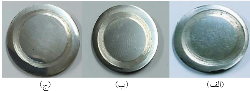
شکل ۱۳- تصاویر سایش نمونه‌های: الف) \text{NiCrAlY}/ 1\% \text{wt Si}_3\text{N}_4 ، ب) \text{NiCrAlY}/ 3\% \text{wt Si}_3\text{N}_4 و ج) \text{NiCrAlY}/ 5\% \text{wt Si}_3\text{N}_4 .
