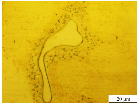
شکل ۵- ریزساختار مربوط به منطقه متأثر از حرارت نمونه جوشکاری شده در سرعت چرخشی ۲۵۰۰ دور بر دقیقه نشان‌دهنده انحلال جزئی رسوبات ناپیوسته \gamma .
