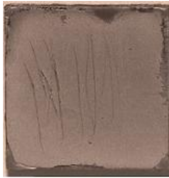
شکل ۶- تصویر سطح نمونه پوشش داده شده پس از آزمون چسبندگی به روش خراشیدن.
