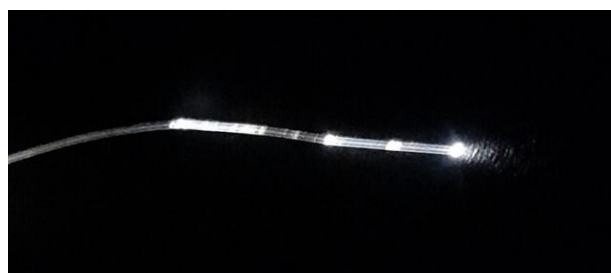
شکل ۸- درخشش نور در فیبر نوری هویه‌کشی شده.
