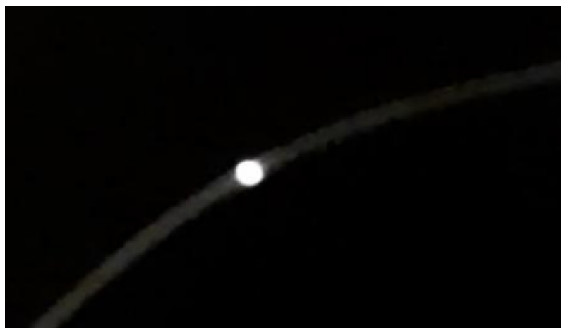
شکل ۱۲- درخشندگی فیبر نوری در اثر ایجاد شکاف با ابزار برش.
