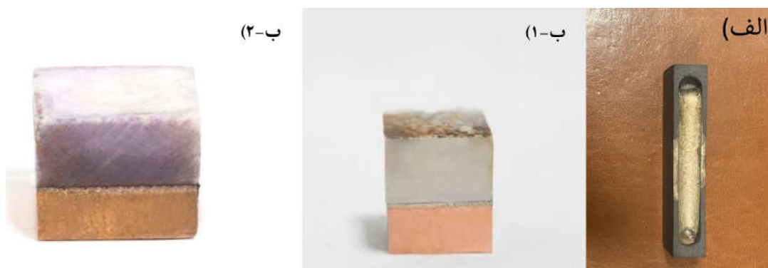
شکل ۱- الف) تصویری از لایه میانی ساخته شده در قالب قایقی گرافیتی، ب-۱) نمونه لحیم‌کاری شده با فلز پرکننده Ag-Cu-Ti-Sn و ب-۲) نمونه لحیم‌کاری شده با فلز پرکننده Ag-Cu-Ti-Sn-5.1Zr.
