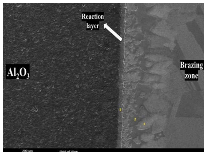
شکل ۱۰- تصویر SEM از اتصال \text{Al}_2\text{O}_3/\text{Cu} با لایه میانی \text{Ag-Cu-Ti-Sn-}5.1\text{Zr} .
