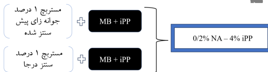
شکل ۱- شماتیک روند ساخت نمونه‌های شماره ۴ و ۵
